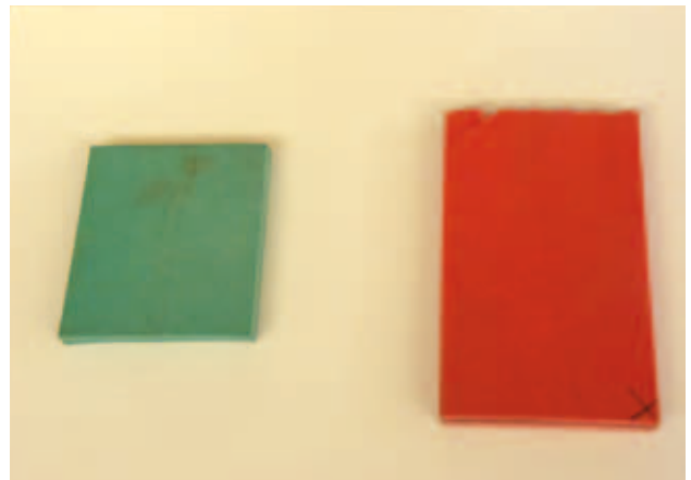
Fig. 15 - Appui élastomère (résilient acoustique)
