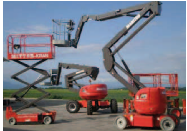
Fig. 5 - Nacelles et plateformes élévatrices
