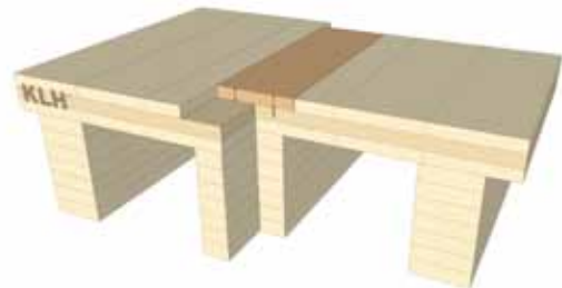
Fig. 7 : Assemblage des éléments par couvre joint
