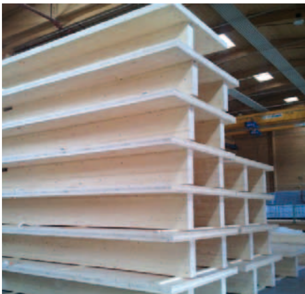
Panneaux nervurés prêts à être chargés
