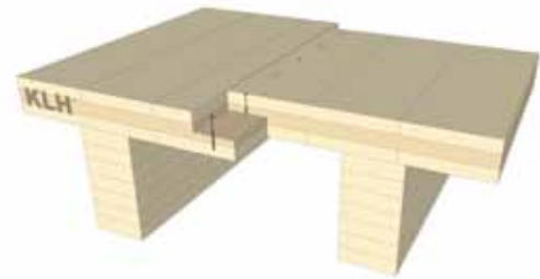
Fig. 6 : Assemblage des éléments par feuilures mi-bois
