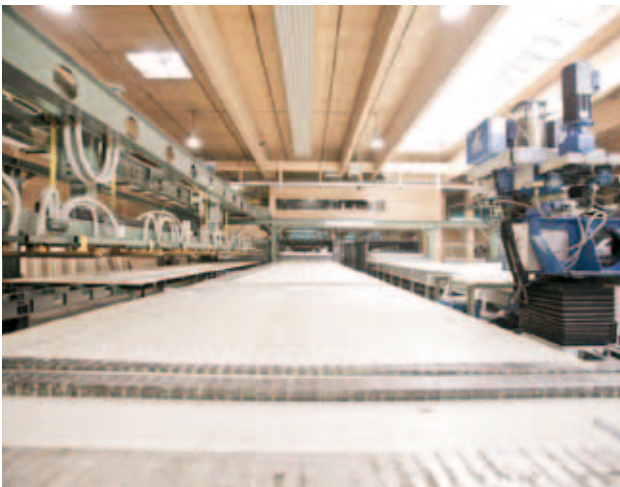
Pour le collage des couches, on utilise uniquement une colle sans formaldéhyde
