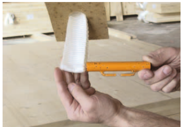
2. Ne pas placer la broche au niveau de la couture de la sangle
