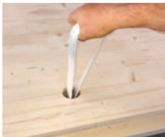
2. Sangle en place pour le montage
