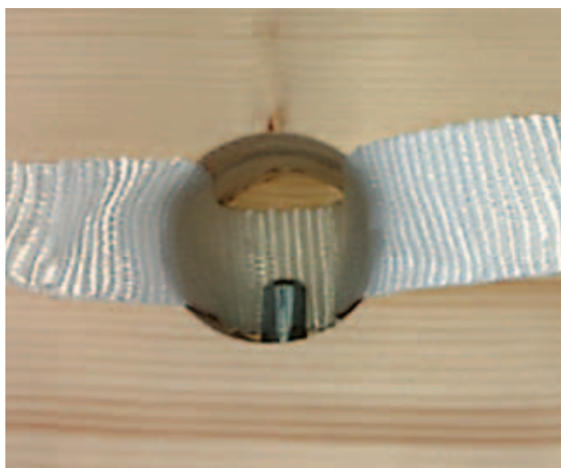
1. Insérer la sangle et la broche dans l'usinage
